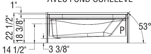
Toutes ces dimensions sont approximatives. Afin d'assurer une installation parfaite, les dimensions de la structure doivent être vérifiées à partir de l'unité.
